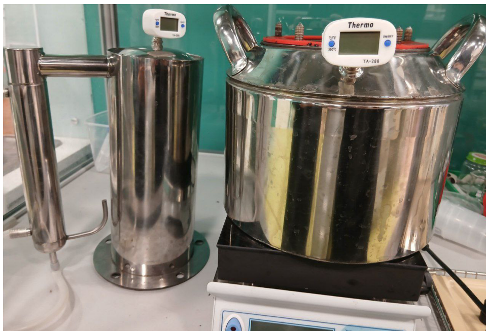
Рис. 2. Установка парового дистиллятора для получения гидролатов из растительного сырья в биохимической лаборатории «Ориона»
