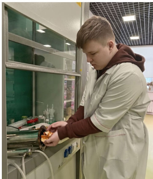
Рис. 5. Закладка растительного сырья в сухопарник
