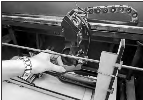
Рис. 9. Настройка фокусного расстояния между объектом и фокусирующей линзой
