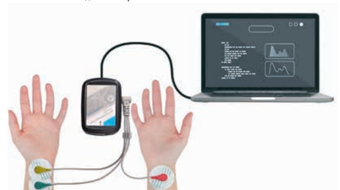
Рисунок 9.3. Расположение электродов для получения сигнала ЭКГ в I отведении
