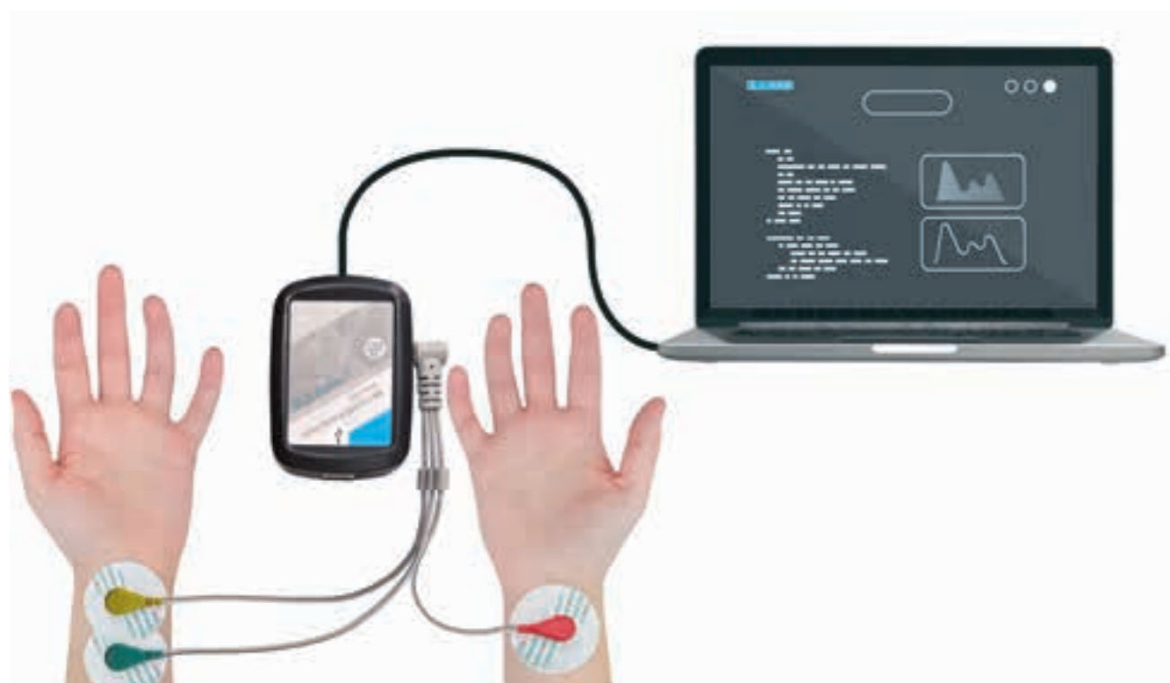
Рисунок 11.6. Подключение электродов для измерения ЭКГ в I отведении
